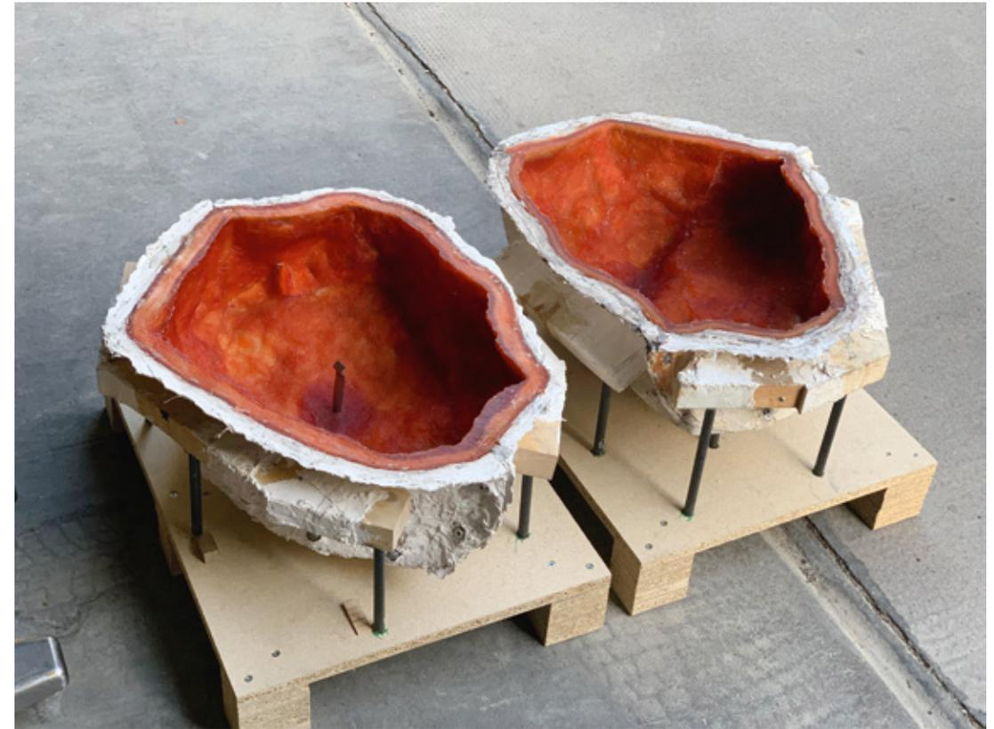
Polyurethanformen für die Betongüsse
