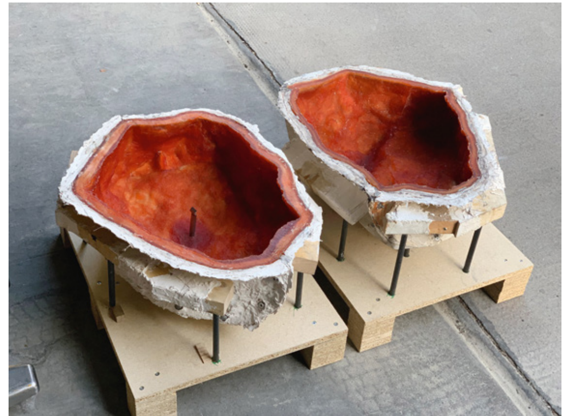
Polyurethane mould for the concrete casts Polyurethanformen für die Betongüsse
