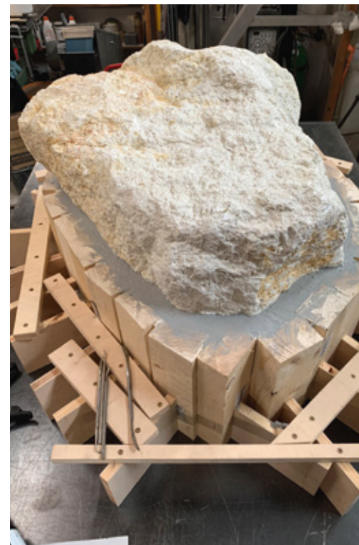
Moulding of a 200 kg limestone chunk Abformung eines 200 kg Kalksteinbrockens
